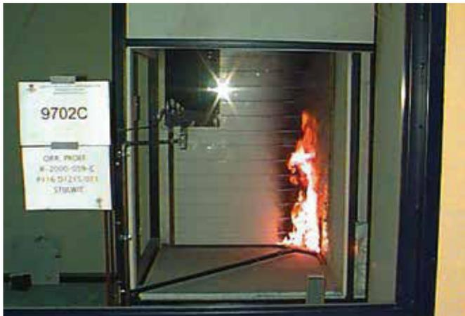
SBI - essai de réaction au feu
