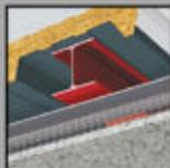
Protection incendie toiture en bac acier isolé et non isolé par Firespray®
